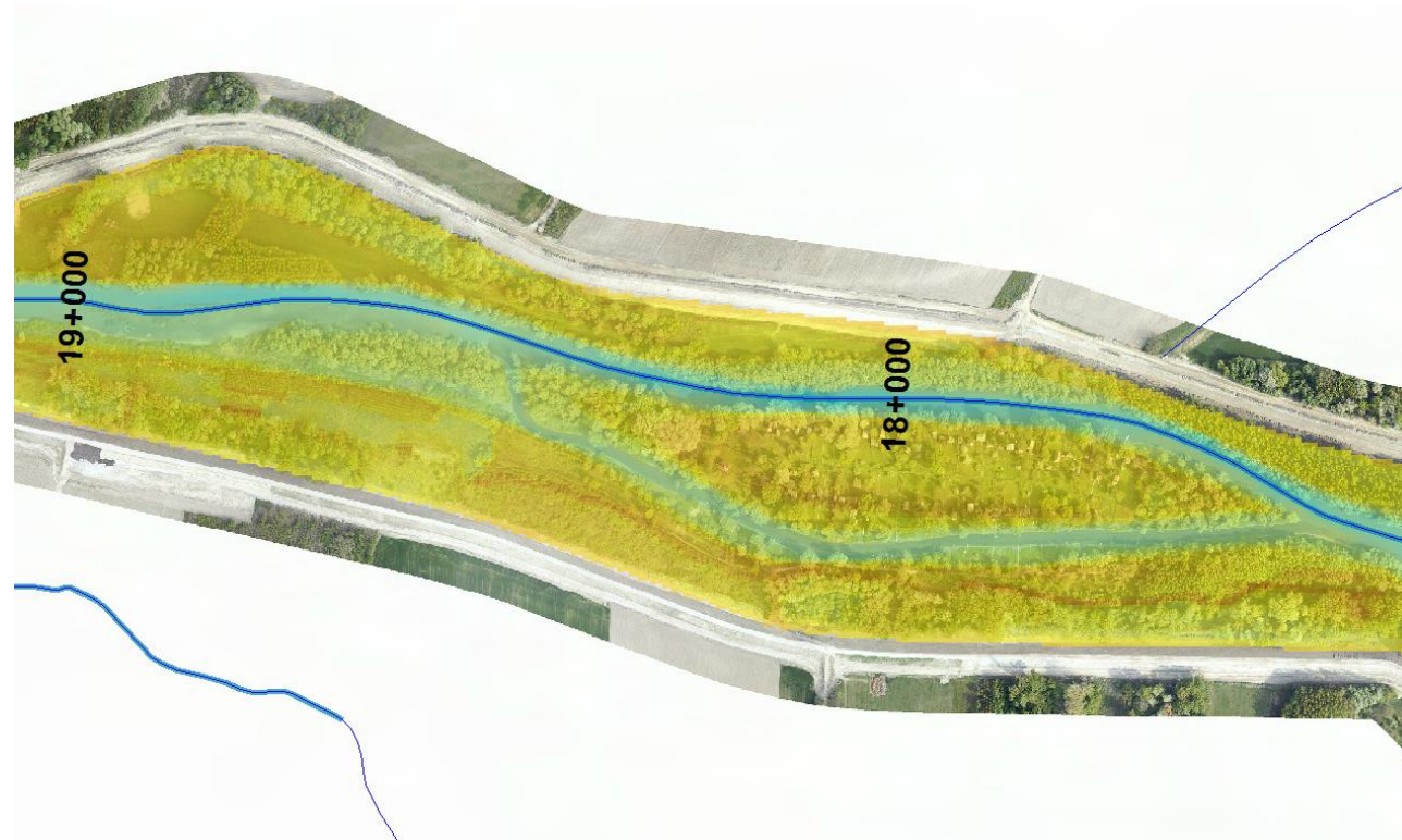
55. ábra: Mosoni-Duna Szúnyog sziget elöntése Dunai árhullám visszaduzzasztás hatására
